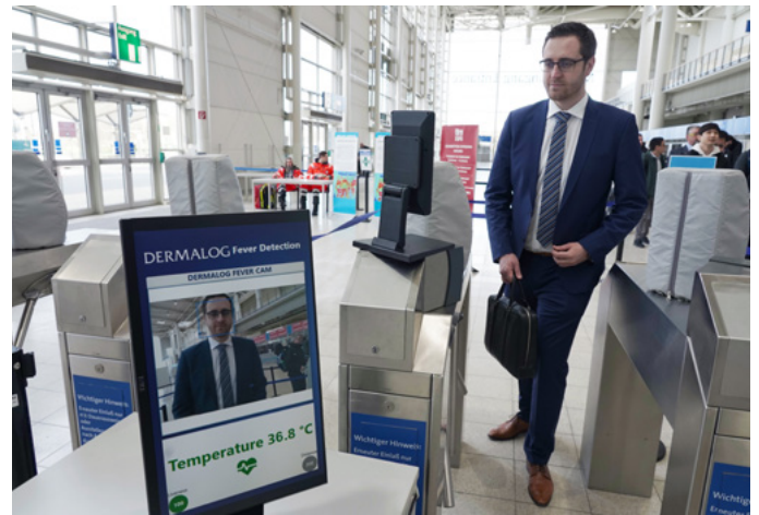
Das DERMALOG-System erfasst die Temperatur jedes Besuchers beim Passieren der Einlasskontrolle und meldet die Messwerte per Bildschirmbenachrichtigung an das Kontrollpersonal.
